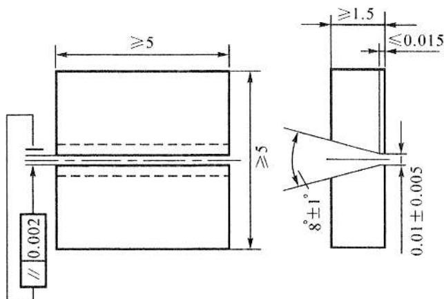
图 4 狹缝光阑的基本尺寸
