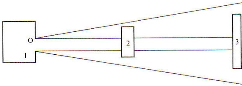
图 7 用星卡测量 X 射线管焦点示意图
