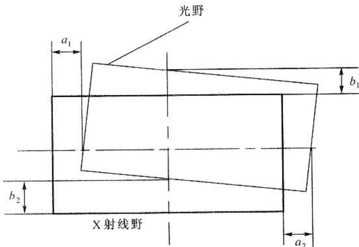
图 3 辐射野与光野的偏差示意图
