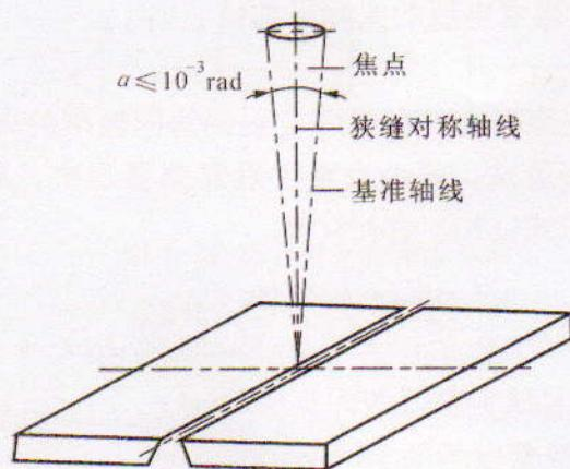
图 5 狹缝照相机的准直
